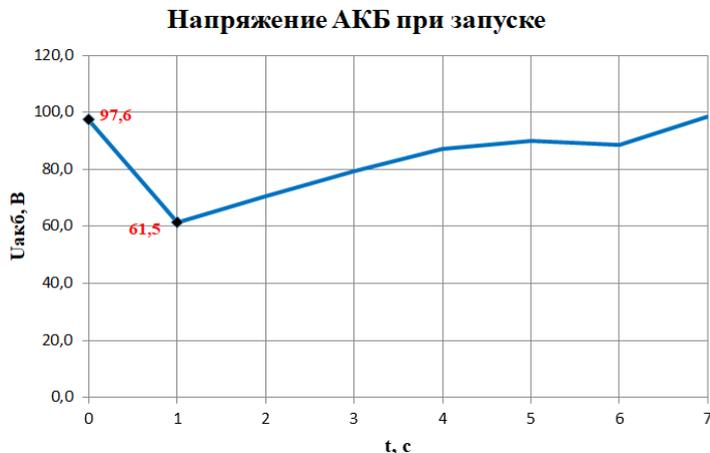
*Рисунок 6. Осциллограмма изменения напряжения аккумуляторной батареи в процессе запуска двигателя с применением стартер-генератора*
