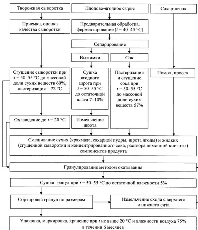
**Рисунок 2.** Технологическая схема производства быстрорастворимого гранулированного киселя из аронии черноплодной с добавлением молочной сыворотки
