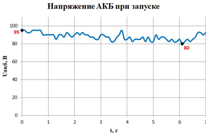
*Рисунок 4. Осциллограмма изменения напряжения аккумуляторной батареи при инверторном запуске двигателя*
