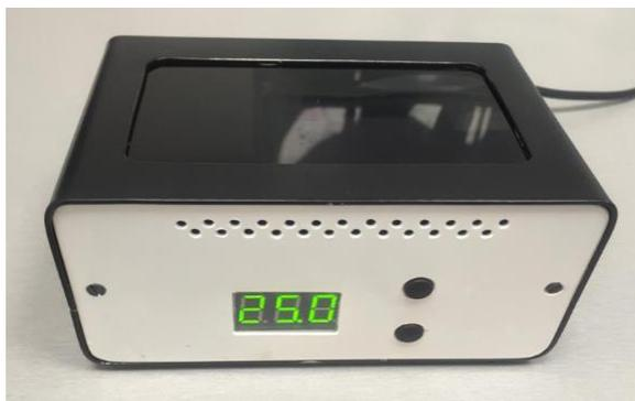
Рисунок 2. Устройство для нагрева композитного материала
