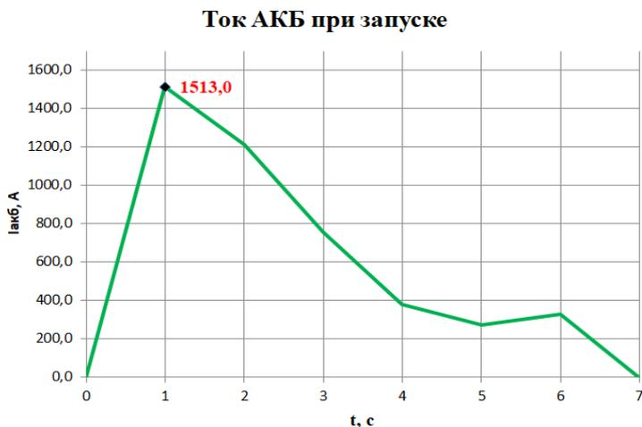
*Рисунок 7. Осциллограмма тока, потребляемого стартер-генератором от аккумуляторной батареи, в процессе запуска двигателя*
